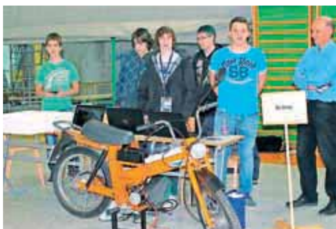
Trije dijaki Šolskega centra Kranj so bencinski motor predelali v električnega.
