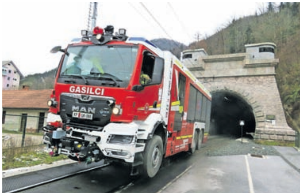
Dvopotni specialni gasilski avtomobil znamke MAN je izdelan v Nemčiji in nadgrajen v Sloveniji. Dolg je 12 metrov, tehta pa 26 ton. Zasnovan je za šestčlansko posadko
