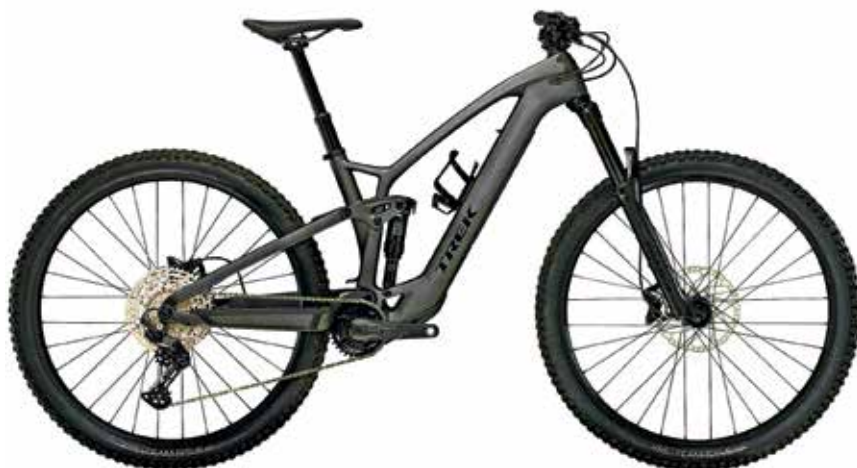
Trek Fuel EXe – nova vrsta gorskega kolesa s karbonskim okvirjem, kompaktnim motorjem TQ, ki omogoča nizko težo in tiho delovanje / Foto: Trek
