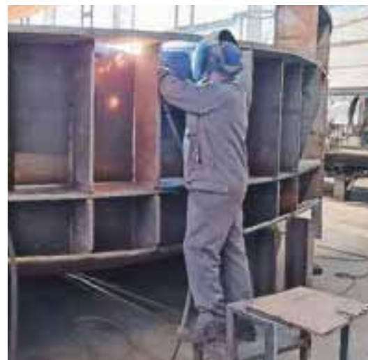
OKVIR IN dno za novo elektroobložno peč v Acroniju
